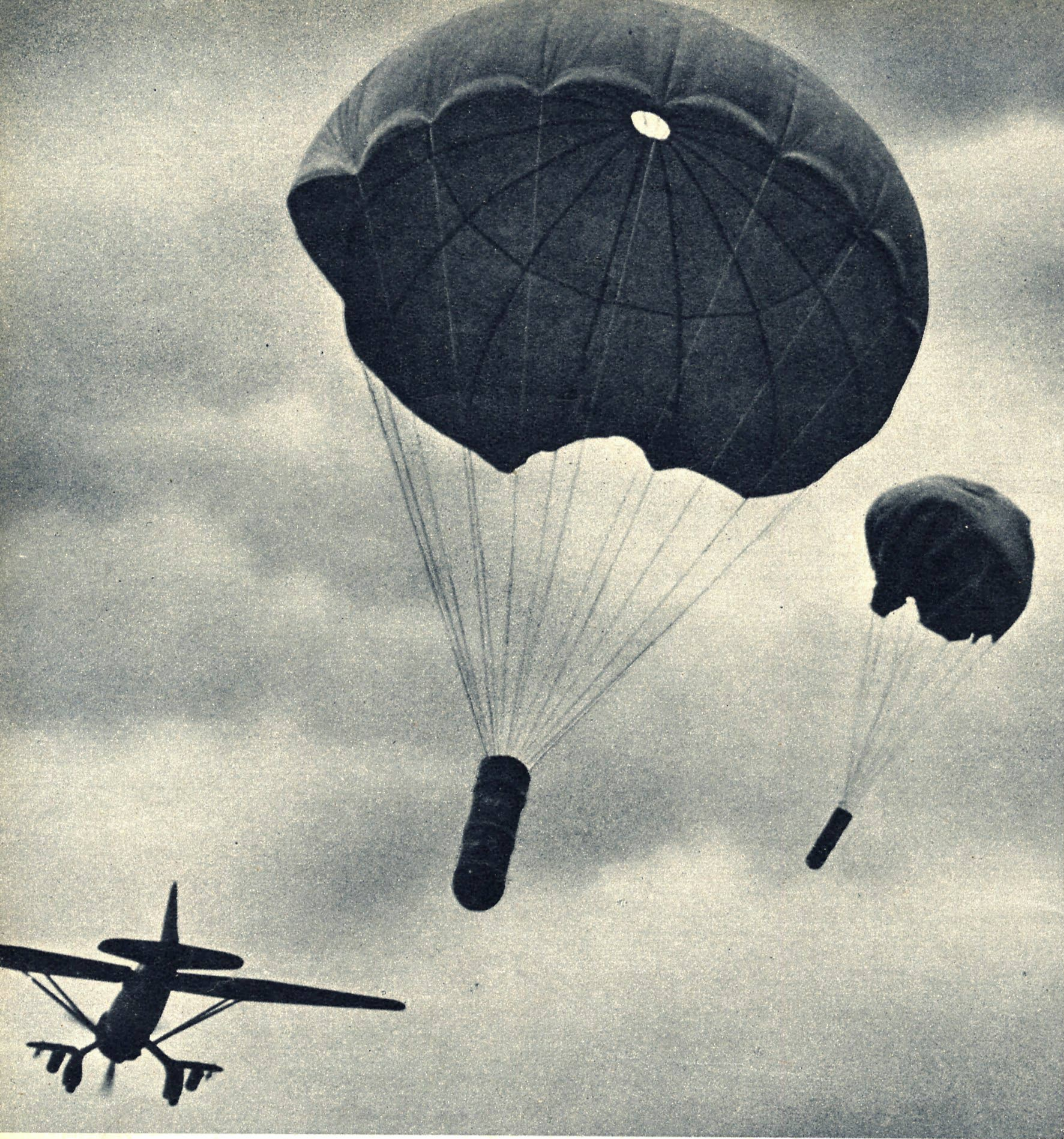
Der Fallschirm, der in der Verschluss-Kappe des Behälters untergebracht war, hat sich automatisch geöffnet
